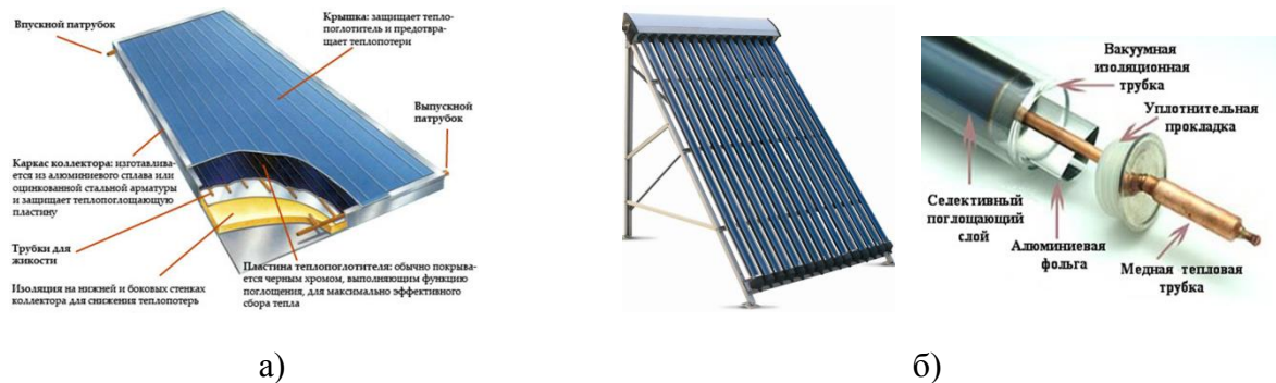
а) б) Рис 1. Основные элементы солнечных коллекторов а) -плоского типа; б) -трубчатого вакуумного типа
