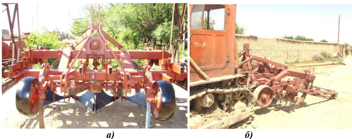
2-расм. Тупроққа эгатсиз текис ишлов берувчи фаол ишчи органли комбинациялашган плуг(ПФР-2) нинг умумий кўриниши: а - орқа кўриниши; б - ён кўриниши.
